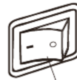
Włącznik w pozycji "1": Maszyna włączona
